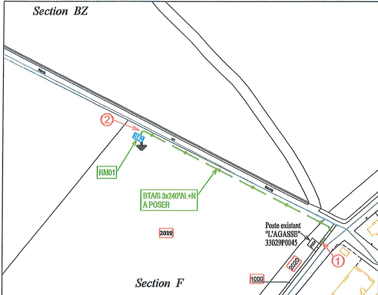
Objet : Pose câble souterrain BTA/S 3x150AL+N + coffret REMBT(RM01)
